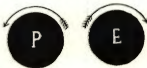
Kuva 237. Molekylivirtojen suunta magnetin polien ympärillä.
