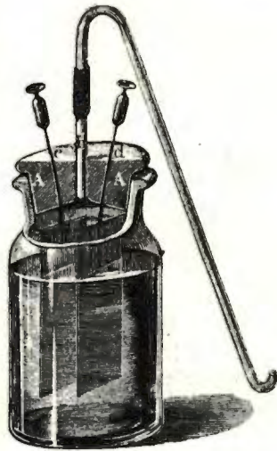
Kuva 220. Veden hajottaminen sähkövirralla.
