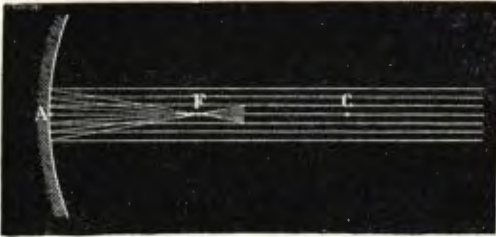
Kuva 145. Koveropeili. AC pääakseli. F pääpolttopiste.
