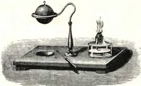
Kuva 95. Lämmitettynä ei pallo mahdu renkaan läpi.
